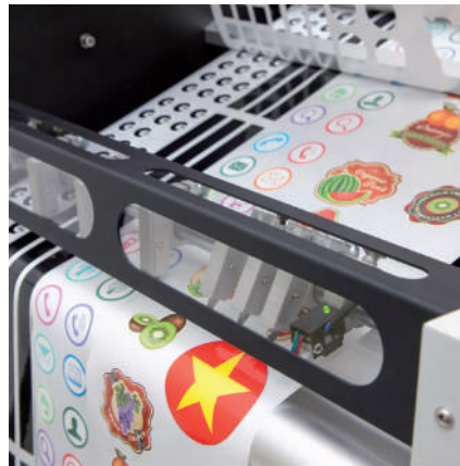
Sistema de corte longitudinal con corrección de borde
