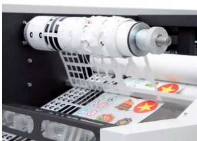
Sistema de tensión y eliminación de residuos
