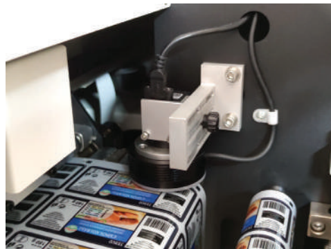
Sistema de cámara CCD para escaneo y precisión en el corte
