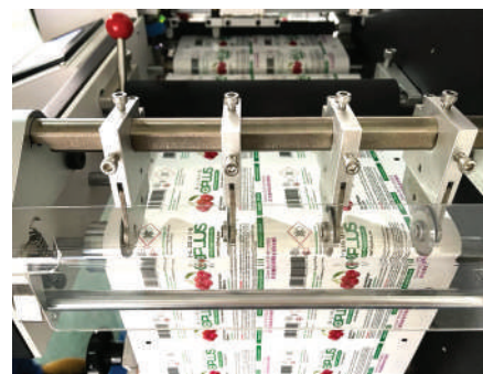
Desde 4 hasta 8 cuchillas separadoras longitudinales
