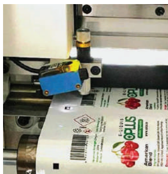
Sistema de posicionamiento a través de marca de registro
