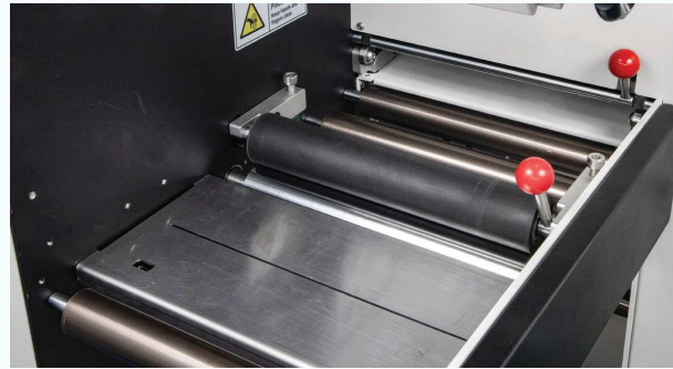
Plataforma de empalme
