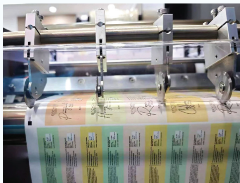
cuchillas de separación longitudinal
